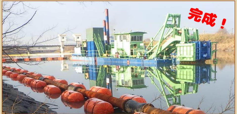
今月中頃しゅんせつ船の組立が完成し、川底の土砂のくみ上げが始まりました。写真のしゅんせつ船を使いバキューム方式で土砂(泥水状です)を吸い上げ、オレンジ色の管を通して仮設のピットにためていきます。ピットに溜まった泥水に薬剤を混ぜ固化したら、ダンプで処分場へ運びます。今回の工事では約40mある川幅の3分の2程を延長350mに渡り、1mほど掘り下げます。工事の目的は、川底の土砂を撤去し底面を掘り下げること、大雨などで水量が増えても対応できるようにする事です。これもまた、皆さんの生活を守るために必要な工事なんですね！
