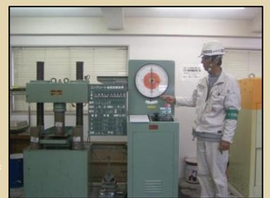
コンクリートを打設する時に一緒に作った円柱状のテストピース（供試体<sup>きょうしたい</sup>といいます）を使って行われる「圧縮強度試験」です。
